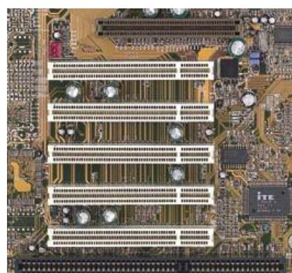
Las tarjetas de expansión son unas tarjetas de circuitos que encajan en las ranuras de expansión o slots de la placa base y que disponen de unos conectores llamados puertos a los que se conectan los diferentes periféricos. Las tarjetas de expansión actúan como
